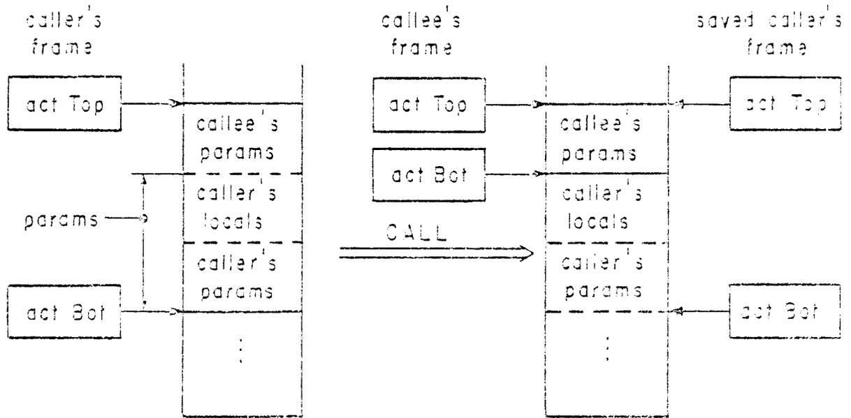
Figure 3-4: Subsystem Call -- Parameter Passing
